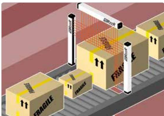
Rilevamento bi-dimensionale di oggetti in transito su sistemi di trasporto con utilizzo di 2 barriere. Se necessario il calcolo del volume può essere realizzato mediante una terza barriera orizzontale, oppure considerando la velocità di transito
