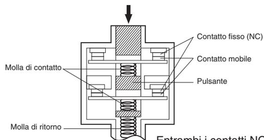
Entrambi i contatti NC sono dotati di un meccanismo di apertura positiva. In caso di saldatura, i contatti vengono separati dall'azione di spinta del pistoncino.
