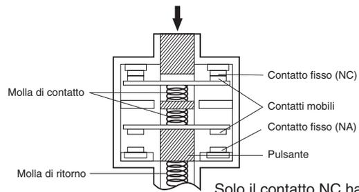
Solo il contatto NC ha un meccanismo di apertura positiva. In caso di saldatura, i contatti vengono separati dall'azione di spinta del pistoncino.
