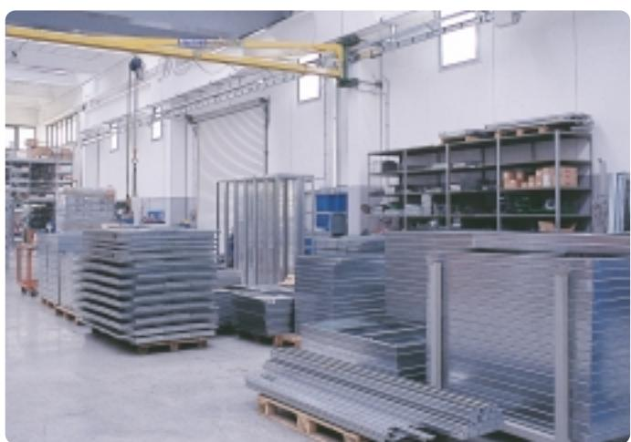
Lamiere per strutture dei quadri BT pronte per l'assemblaggio
