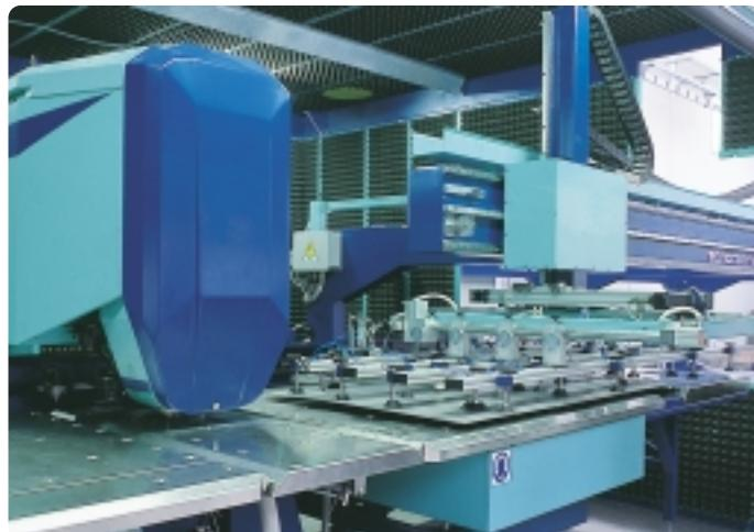
Punzonatura delle lamiere per strutture dei quadri BT
