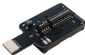
Interfaccia di programmazione parametri per i dimmer della famiglia ETL4xx.
