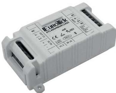
Interfaccia digitale per il dimming di alimentatori AC/DC generici, con ingresso di controllo PWM. L'interfaccia è dotata di un relè per il distacco del primario dell'alimentatore, consentendo la gestione ON/OFF del punto luce.
