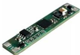
Dimmer dotato di  **sensore ottico**, mono-canale con uscita in tensione di tipo PWM. Consente accensione, spegnimento e regolazione dell'intensità luminosa senza che l'utente tocchi il dispositivo. È sufficiente avvicinare la mano o il dito per azionarlo.
