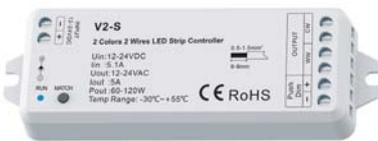
LED dimmer con controllo a radiofrequenza.
