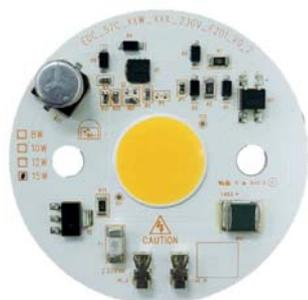
LED alimentati direttamente a 230VAC ad elevate performance ed elevata luminosità.
