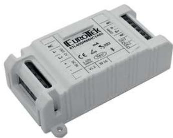
Dimmer mono-canale con uscita in tensione PWM ad alta frequenza, controllabile da pulsante isolato (oltre che da segnali in tensione, protocollo DALI e potenziometro), per gestione ON/OFF e regolazione dell'intensità luminosa.
