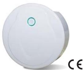
WiFi-Relay funziona come gateway o hub Wi-Fi convertendo il segnale Wi-Fi in frequenza. È compatibile con alimentatori e dimmer Skydance RF 2.4GHz e permette di controllare da smartphone luci a colore singolo, a due colori (CCT), RGB, RGBW ed RGB + CCT.
