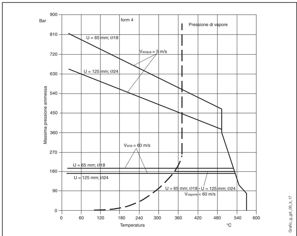
Fig. 3: Grafico pressione/temperatura per pozzetto a saldare in 13CrMo4-5/1.7335
