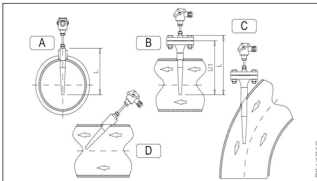
Fig. 4: Esempi d'installazione
