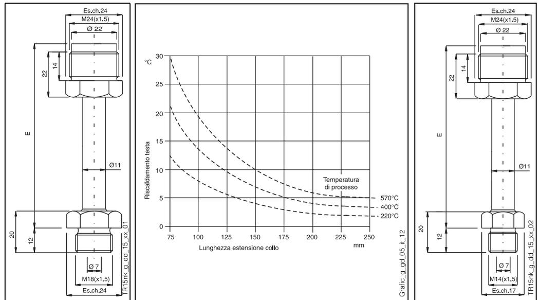
Fig. 8: Collo d'estensione (nelle due diverse dimensioni) e grafico relativo al riscaldamento della testa conseguente alla temperatura del processo
