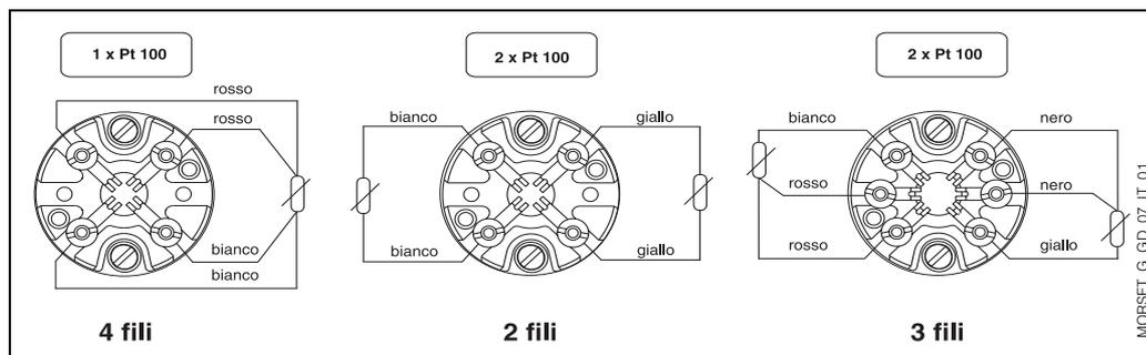
Fig. 11: Schemi elettrici standard (morsettiere ceramica)
