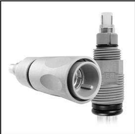
L'orientamento dell'innesto e dell'accoppiamento viene eseguito solo sulla custodia in PPS. Questo consente di eliminare qualsiasi stress meccanico dei contatti.
