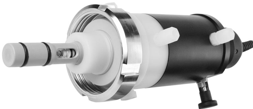
Questa armatura compatta a deflusso, consente di pulire, calibrare e sostituire l'elettrodo in automatico, a serbatoio pieno o in condizioni di processo, con pressioni sino a 6 bar. Il materiale a contatto con il prodotto è di tipo sintetico.
