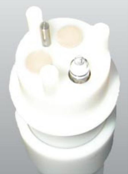
Vista dal basso del supporto dell'elettrodo con un elettrodo installato e potenziale di massa del liquido
