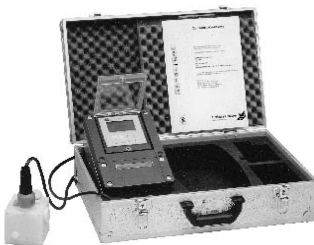
L'acqua ultra-pura è utilizzata nell'industria farmaceutica ed alimentare e nell'ingegneria di processo. Per queste applicazioni, la verifica e la calibrazione del processo di misura della conducibilità sono obbligatorie.
