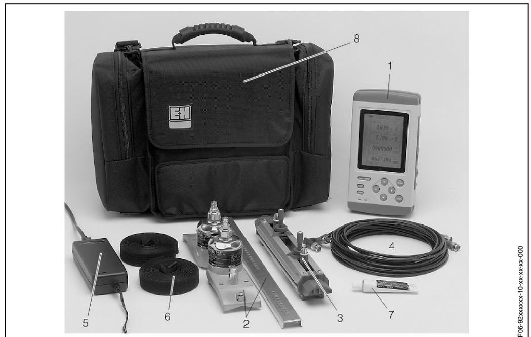
1 = Trasmettitore Prosonic Flow 92; 2 = Sensori Prosonic Flow W, supporti dei sensori e dima di posizionamento; 3 = Assemblaggio dei sensori Prosonic Flow U; 4 = Cavi di connesione dei sensori; 5 = Carica batteria; 6 = Fascette bloccanti; 7 = "Pasta" di accoppiamento; 8 = Borsa per il trasporto
