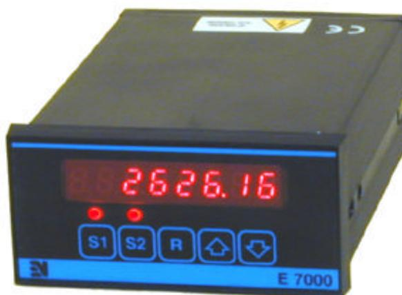
Il totalizzatore della serie E7000-20 è uno strumento compatto flessibile a microprocessore in grado di integrare una variabile analogica e totalizzarla nel tempo. E' alloggiato in un contenitore DIN 96x48mm adatto per in montaggio a fronte quadro.
