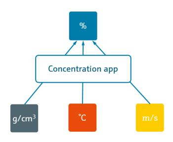
La "app concentrazione" permette la misura della concentrazione nel mezzo selezionato basata sui valori misurati di velocità del suono  $C_F$ , densità  $\rho_F$  e temperatura  $\vartheta_F$ . Per ogni fluido viene infatti generata un'impronta acustica che viene sottoposta a un'analisi multivariata che effettua una mappatura del fluido.
