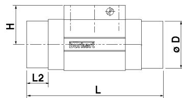
4.7: Raccord en PVC/PP/PVDF; avec embouts à coller / à souder
