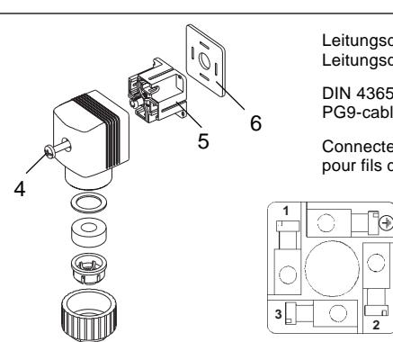
Leitungsdose nach DIN43650 mit PG9-Verschraubung, Leitungsquerschnitt bis max. 1,5 mm², Schutzart IP65.
