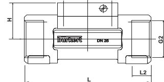
Rc-Anschlussgewinde / Rc-Port connection / Raccordement Rc
