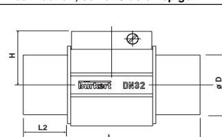
3.7: Raccord en PVC/PP/PVDF; avec embouts à coller / à souder
